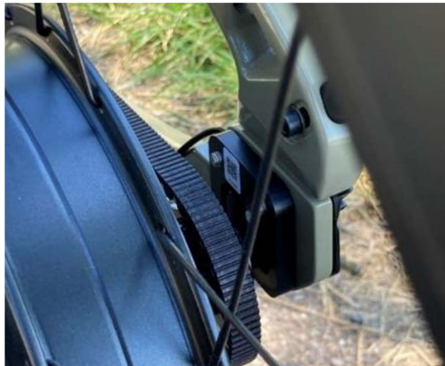
Abbildung 7: Zweite Gabel mit befestigtem Drehmomentsensor (aus Massnahmegesuch)
